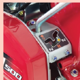
Cần số và bộ hộp số bao gồm 2 số tới và 1 số lùi giúp điều chỉnh tốc độ di chuyển của máy
