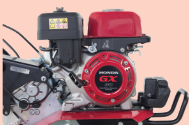
Sử dụng động cơ GX80, công suất 2.3Hp
